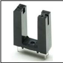
SG2C05は、高出力赤外発光ダイオードと高感度フォトランジスタを組合わせた透過型フォトインタラプタです。高精度位置検出に適した汎用インタラプタです。
